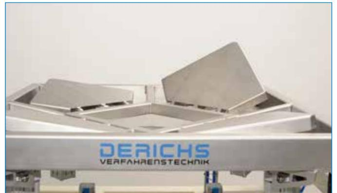
Die Big-Bag-Entleerstation LEB wird eingesetzt, um Big-Bags mit konfektioniertem Auslauf zu entleeren. Die hygienisch optimierte Konstruktion eignet sich besonders für den Einsatz in Nahrungsmittel- und Pharmaanlagen.
