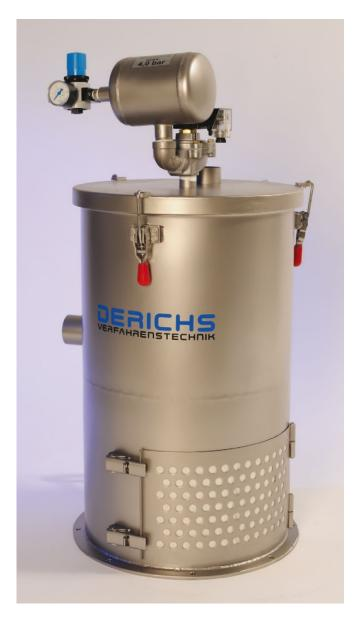
Das Saugfördergerät FPS wird zur diskontinuierlichen, pneumatischen Förderung von Pulvern und Granulaten in der Nahrungsmittel-, Kunststoffindustrie oder Chemie eingesetzt. Durch die kompakte Bauweise eignet sich das Saugfördergerät besonders für die Beschickung von beispielsweise Paniermaschinen, Abfüllmaschinen, Extrudern und Dosiergeräten. Die Produktaufgabe kann z.B. aus einem Silo, einer Big-Bag-Entleerstation oder einer Sackeinschüttkabine erfolgen.
