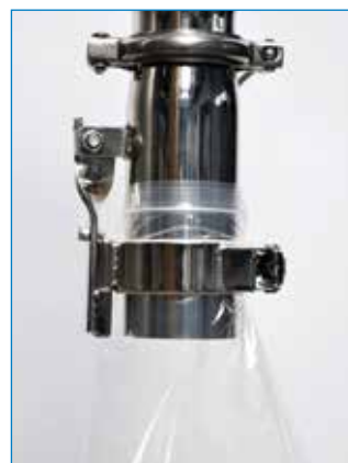
Andocksystem zur Befestigung kleiner Beutel
