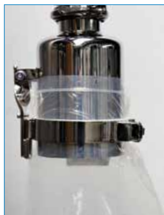
Andocksystem zur Befestigung großer Beutel
