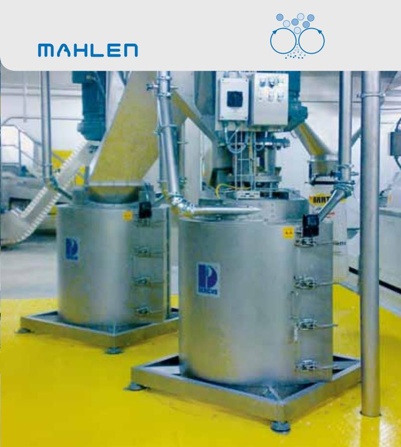
Um einen sicheren Materialfluss in Ihrer Produktion zu gewährleisten, werden häufig Klumpenbrecher oder Siebbrecher benötigt. Im Bereich der Paniermehlherstellung haben wir spezielle Mühlen für Brot oder Produkte ähnlicher Konsistenz entwickelt. Shredder für eine gröbere Kornstruktur oder Schneidmühlen für feinere Kornformen sorgen für die gewünschten Produkteigenschaften. Für spezielle
