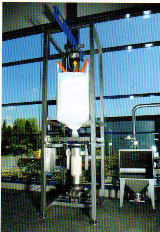
Big-Bag-Entleerstation mit Hebevorrichtung und Austragschleuse
