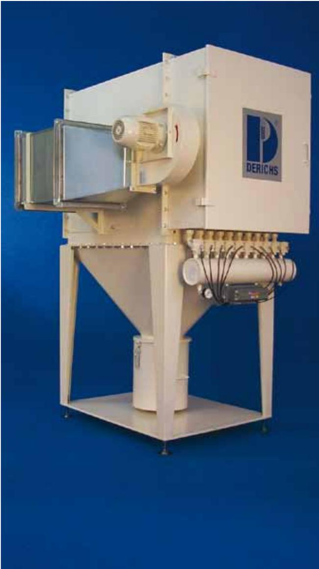
Das Zentralfilter TFZ wird eingesetzt zur Entstaubung von Schüttgutssystemen, wie zum Beispiel Befüll- und Entleersysteme für Säcke, Big-Bags und Lkw bzw. Silofahrzeuge. Das integrierte, pneumatisch gereinigte Taschenfilter ermöglicht den Einsatz des Zentralfilters auch bei hygroskopischen und anbackenden Pulvern bzw. Granulaten.
