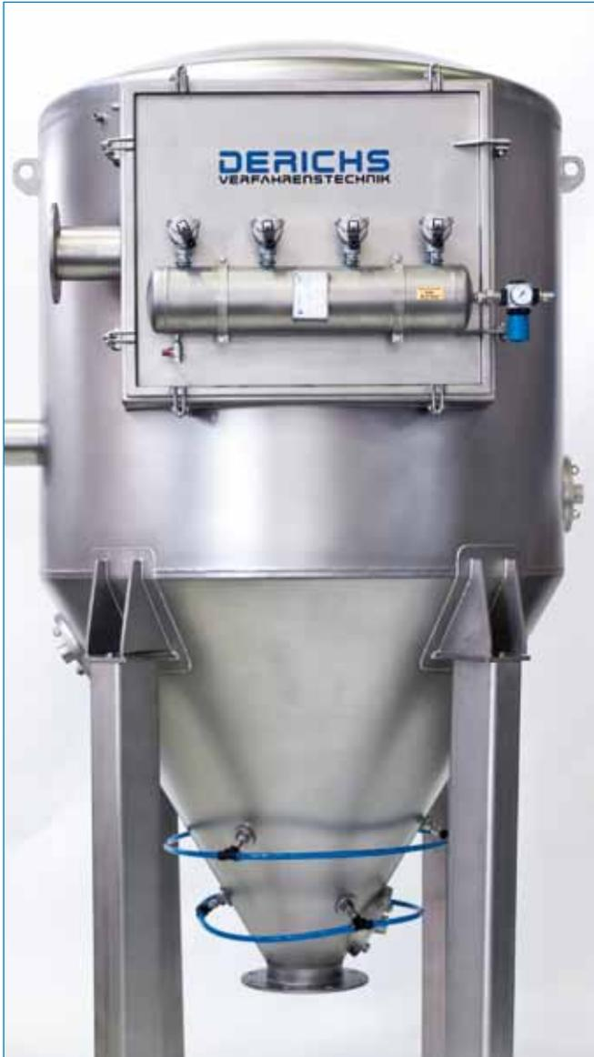
Der Abscheider TAF findet seinen Einsatz zur Produkt-/Lufttrennung in Entstaubungs- und pneumatischen Fördersystemen. Das integrierte, pneumatisch gereinigte Taschenfilter ermöglicht den Einsatz des Abscheiders bei hygroskopischen, anbackenden Pulvern und Granulaten. Der Abscheider ist lieferbar in Durchmessern von 600 bis 1600 mm und Filterflächen von 2 bis 19 m<sup>2</sup>. Für schwerfließende Produkte kann der Auslauftrichter mit einer Austraghilfe bzw. -vorrichtung ausgerüstet werden.
