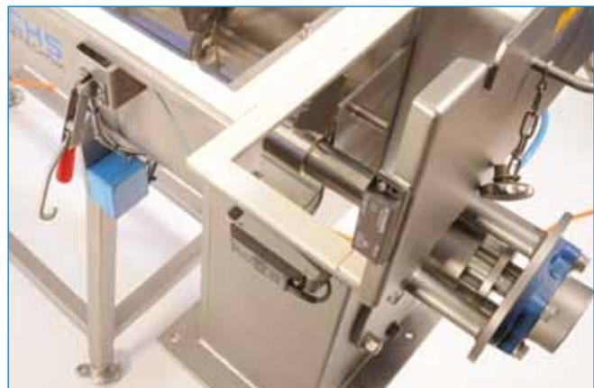
Das hier abgebildete Gerät ist mit allen notwendigen Sicherheitsschaltern ausgerüstet und ermöglicht somit eine einfache und sichere Reinigung.
