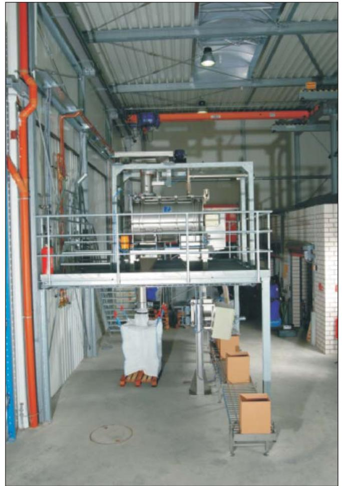
Komplettansicht der Abfüllanlage mit Mischer und Abfüllstation für Big-Bags und Kartons
