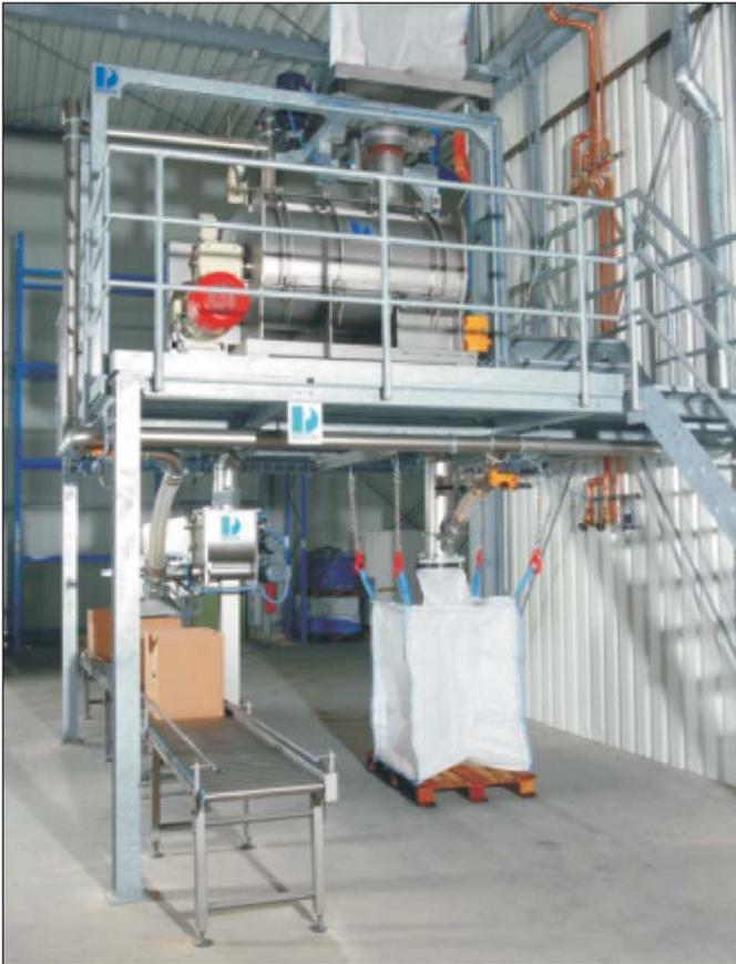
*Integriert: Abfüllstationen zum Verpacken der Endprodukte in Big-Bags oder Kartons*
