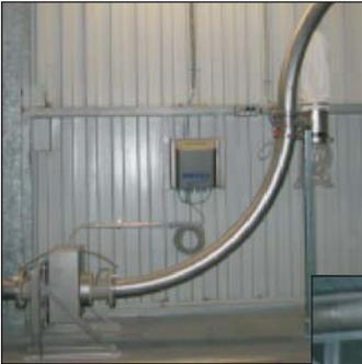
Probenahme und Metallsuchspule in einer pneumatischen Förderleitung
