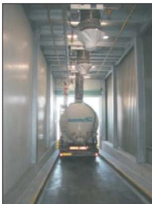
*Schwerkraft LKW-Befüllung mittels Teleskopverladegaritur*
